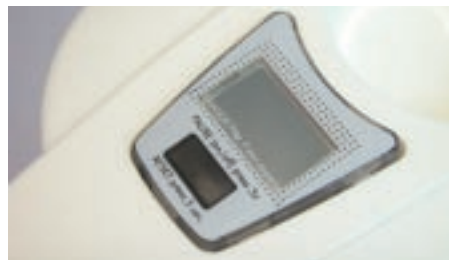
Ein Zwei-Komponenten-Spritzteil mit Dichtung und Druckschalter, bestehend aus ABS und der elastischen Komponente TPE, das bei Camo auch online bedruckt wird.
