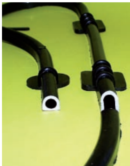
Abb. 2: Fluidinjektionstechnik im Elastomerspritzgießprozess
